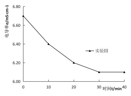
图 4 酶洗过程纳浓侧电导率随时间的变化
