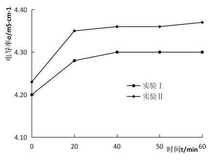
图 2 碱洗过程纳浓侧电导率随时间的变化
