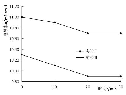
图 3 酸洗过程纳浓侧电导率随时间的变化
