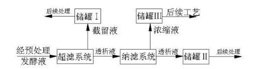
图 1 双膜法处理红霉素发酵液工艺流程
