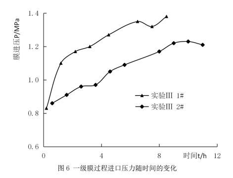
碱酸清洗法和酶碱酸清洗法清洗后一级膜过程的进口压力都低于普通碱酸法清洗后一级膜过程的进口压力。酶清洗剂能分解膜表面和膜孔内的蛋白质类、氨基酸类等的有机污染物,使膜表面和膜孔内的阻力减小,所以酶碱酸清洗法清洗后一级膜进口压力降低的程度要大于碱酸清洗法。从图 6 中取点计算平均值得压力降低的程度的约为 20%。
